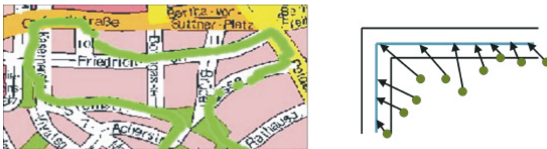
Abbildung 4: Detailansicht der Positionierung mit PointMan und extern eingespeistem GPS-Signal in der Bonner Innenstadt (links). Ungenauigkeiten (z.B. „Schneiden der Kurve“ durch Häuserblock) können mit MapMatching Techniken korrigiert werden. Rechts: Prinzipskizze
