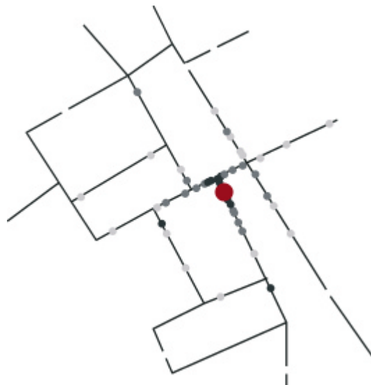
Abbildung 5: Stufe 3 des Partikelfilters: Die Proben sind bewertet (schwarz = hohe Wahrscheinlichkeit, weiß = geringe Wahrscheinlichkeit) und die Probe mit der höchsten Wahrscheinlichkeit wird als aktuelle Position ausgewählt.
