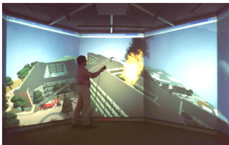
Abbildung 6: Direkter Zugriff auf das 3D-Modell des Recklinghäuser Kreishauses über die W3DS-Schnittstelle der Simulationsumgebung COSIMIR (hier ein Brandbekämpfungsszenario im CAVE mit 360° Rundumprojektion). Foto: W. Herzberg
